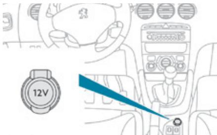
☞ Чтобы подключить к прикуривателю электрический прибор, работающий от напряжения 12 вольт (мощностью не более 120 ватт), откройте заглушку прикуривателя и вставьте в него соответствующий штепсель прибора.
