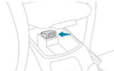
Через вход USB можно подсоединять к бортовой аудиосистеме внешние устройства - например, цифровой плеер типа iPod® или флеш-карту USB.
