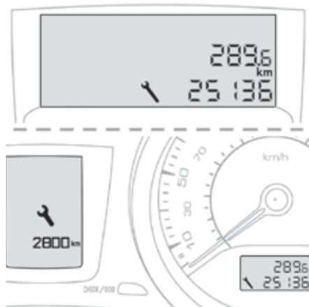
Эта информация выводится на дисплей на несколько секунд при включении зажигания. В ней водителю сообщается о пробеге, который осталось пройти автомобилю до очередного технического обслуживания в соответствии с регламентом, разработанным изготовителем.
