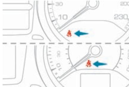
При включении зажигания на панели приборов загорится сигнализатор, если водитель не пристегнул свой ремень безопасности.
