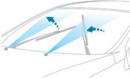
Потяните рычаг стеклоочистителя **A** на себя. При этом стеклоомыватель и стеклоочиститель будут работать вместе до тех пор, пока Вы не отпустите выключатель. Они работают раздельно при выключенных фарах ближнего и дальнего света.
