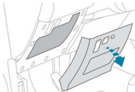
Этот блок предохранителей расположен под панелью приборов (с левой стороны).
