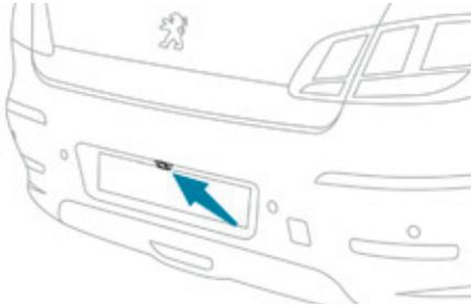
Видеокамера заднего обзора автоматически активируется при включении передачи заднего хода.
