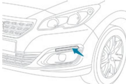
Светодиодные огни (LED) включаются автоматически при пуске двигателя.
