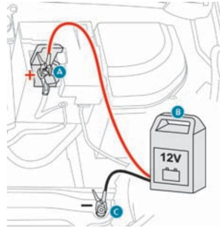
**!** Никогда не пытайтесь зарядить замерзшую батарею - она может взорваться. Если она замерзла, проверьте ее состояние в сервисной сети PEUGEOT или в специализированном техцентре - там проконтролируют ее внутренние элементы и проверят корпус на отсутствие трещин, через которые может просочиться разъедающая токсичная кислота.
