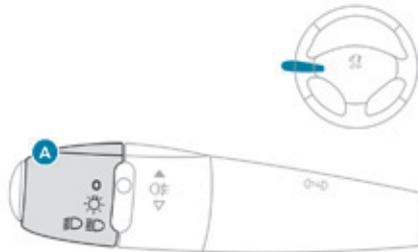
Управление включением световых приборов осуществляется самим водителем при помощи кольцевого переключателя **A** и ручки **B**.
