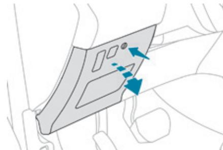
Специальный пинцет для предохранителей расположен на обратной стороне крышки блока предохранителей в панели приборов. Для доступа к ним:
