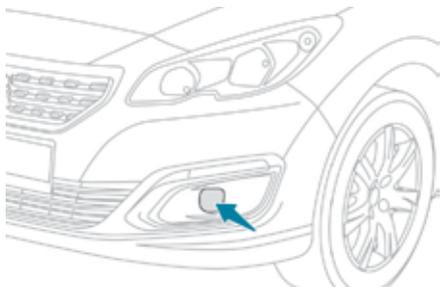
При движении на ближнем или дальнем свете, эта функция служит для освещения противотуманными фарами внутренней траектории виража, если скорость автомобиля менее 40 км/ч (при движении по городу, по извилистой дороге, при проезде перекрестков, при маневрировании на стоянке и т.п.).
