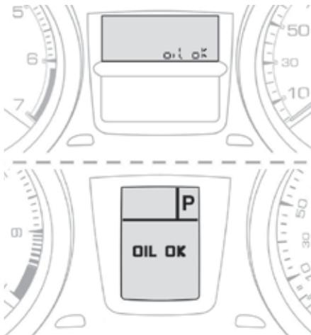
На автомобилях с электрическим датчиком уровень масла в двигателе показывается на несколько секунд на панели приборов сразу после включения зажигания и информации о ТО.
