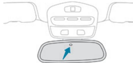
Датчик освещенности определяет яркость расположенного за автомобилем источника света, и внутрисалонное зеркало заднего вида плавно регулируется в режиме день/ночь.
