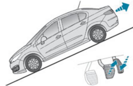
При трогании под гору автомобиля с включенной задней передачей он на мгновение удерживается на месте после отпущения педали тормоза.
