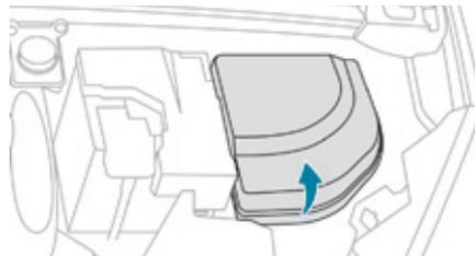
Этот блок предохранителей расположен в моторном отсеке возле аккумуляторной батареи (с левой стороны).
