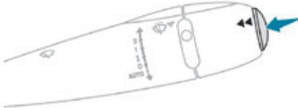
☞ Нажмите на кнопку, расположенную на торце **выключателя стеклоочистителя**, чтобы последовательно вывести на дисплей компьютера различные параметры.
