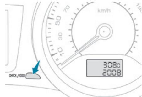
Этот прибор служит для измерения расстояния, пройденного автомобилем с самого начала его эксплуатации.
